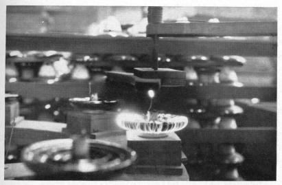
SUSPENSION INSULATORS ON THE REGULAR ROUTINE HIGH FREQUENCY TEST
