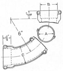
Fig. 272. G. R. S. Split Elbow for Conduit
