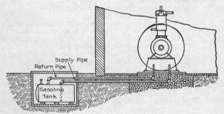
FIG. 116. GASOLINE TANK LOCATION
