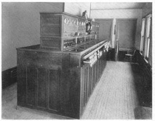
FIG. 29. MODEL 2 UNIT LEVER TYPE INTERLOCKING MACHINE. COLLIN-WOOD INTERLOCKING PLANT, L. S. & M. S. R'Y. (See Fig. 32)
